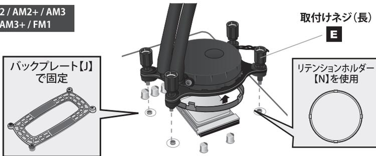
①ヘッドユニットにリテンションリング【I】をセットし、リテンションホルダー【N】で固定します。マザーボードへの固定はバックプレート【J】を使用します。
