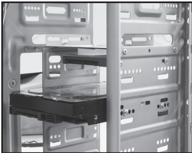
HDDドライブ 2.5インチHDDドライブ 2.5インチHDDドライブは、3点留めになります。
