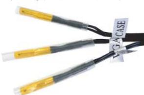
左図の温度センサーケーブルを任意の計測場所に設置して下さい。設置の際は温度センサー素子(先端部)に圧力が掛からないようご注意ください。
