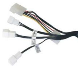
左図の3ピンオスコネクタにお使いのファンを接続して下さい。4ピンコネクタタイプのファンはパルス信号線がないため3ピンコネクタに変換して接続されても本ファンコントローラーの機能はお使いになれません。左図の4ピンコネクタは電源供給用となりますのでご使用の電源と接続して下さい。4ピンコネクタタイプのファンを接続しないようご注意ください。
