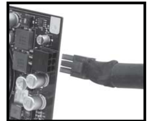
写真はPCI-E(6ピン)仕様のグラフィックスカードのものになります。
