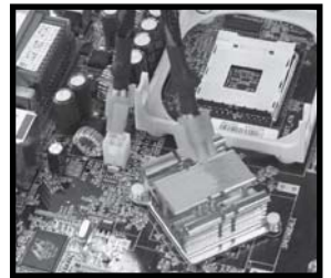
電源側 ATX12V (4ピンのみ使用)
