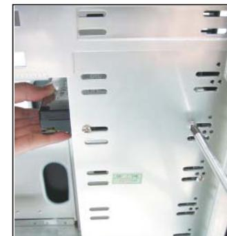
2. 任意の5インチベイにHDDを挿入して下さい。
