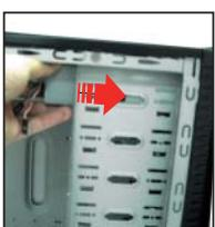
5. 4番で組み上がったFDDトレイを本ケースの5インチベイに挿入しネジ穴位置を合わせて下さい。
