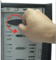
1. ドライブベイで固定されてるスクリューレスキットを外して下さい。
