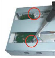
4. FDDトレイと3.5インチデバイスのネジ穴位置を合わせて、付属のミリネジで固定して下さい。
