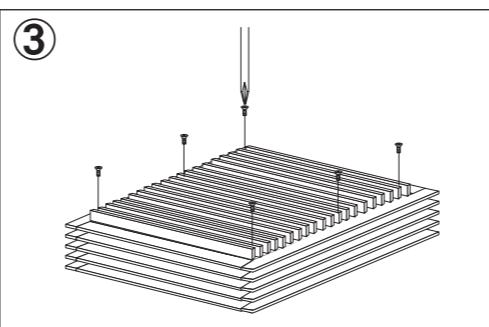
ケース固定用ネジ6本を用いてケース蓋部分とケース下部を固定して下さい。
