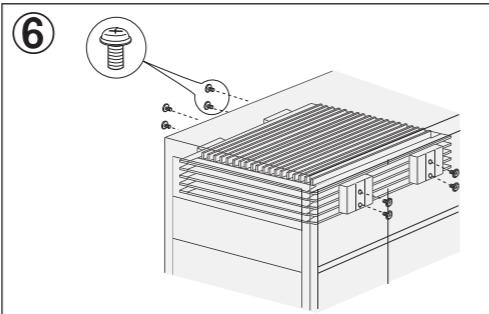
パソコンケース取り付け用ネジを用い氷室本体をパソコンケースに固定して下さい。(ネジを強く締めすぎると本体内部の金属部分がゴム部分より剥離する恐れがあります。)
