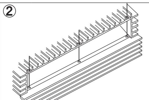
ケース蓋部分をハードディスクが取り付けられたケース下部に被せて下さい。(ケース蓋部分のネジ穴とケース下部のネジ穴が重なる様に被せて下さい。)
