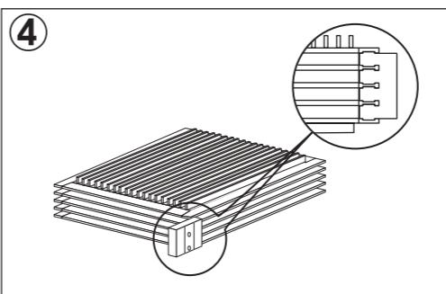
図を参照して、防振ネジ受け4つを氷室本体に装着して下さい。硬質タイプ防振ラバー付きネジ受けの取り付け位置は、お客様のご使用しているパソコンケースや収納方法によって取り付け場所を換えて下さい。
