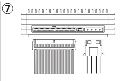
最後にご使用になるハードディスクの種類のケーブルをHDDに取り付けて下さい。
