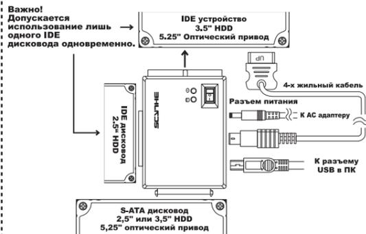
**Важно!** Допускается использование лишь одного IDE дисковод одновременно.
