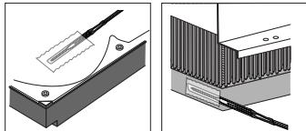
注意: 温度センサーをCPUとCPUクーラー(ヒートシンク)の間に挟まないで下さい。CPUの冷却能力が著しく低下し、機器を破損するおそれがあります。
