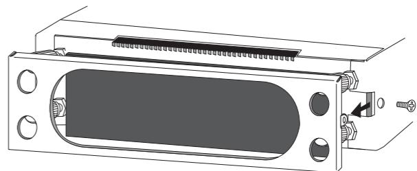
前面パネルの両側侧面のネジを外し、パネルを前に引き出します①。
