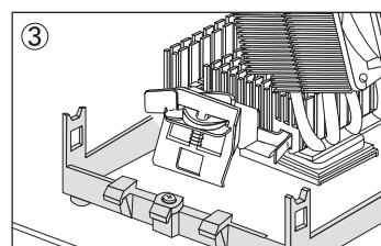
コア接触面がCPUのコア部分と平行になるように載せて下さい。
