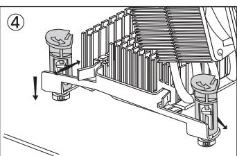
CPUソケットの周りにある4つの穴に、LGA用取り付け金具のアンカーの半透明部分を差し込んだ後、アンカーブラック部分を下にカチリとなるまで押して下さい。取り付けの際は、アンカーブラック部分でマザーボードを傷つけないようにお気を付けて下さい。
