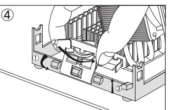
取り付け金具の切り欠き部分をプラケットの両方の突起に取り付けます。取り付け金具についているレバーを図のように指で揃んで回しますと切り欠き部分が上方に移動しクーラー本体を固定します。
