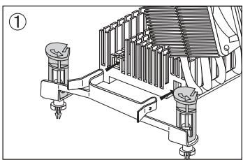
クーラー本体底面(コア接触面)の保護シートを引き剥がし、図のようにLGA用取り付け金具をクーラー本体にカチリというまで奥に完全に押し込み取り付けます。
