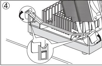
取り付け金具の留め具部分をプラケットの4つの穴に差し込んで下さい。取り付け金具を取り付ける際、ラケット部分を損傷しないようお気を付けて下さい。
