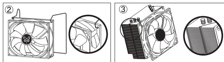
92mmファンに、付属の92mmファン装着用クリップの先端部分をファンのネジ穴部分に抜けないようにしっかりと挿し込んで下さい。
