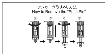
①上方に引っ張れないよう固定されてますので黒い部分を図の矢印方向に回転させて上方に引っ張るようにします。
