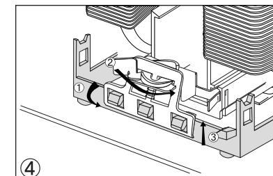
金具の切り欠き部分をブラケットの突起に取り付けます。金具についてるレバーを図のように回しますと切り欠き部分が上方に移動しクーラー本体を固定します。
