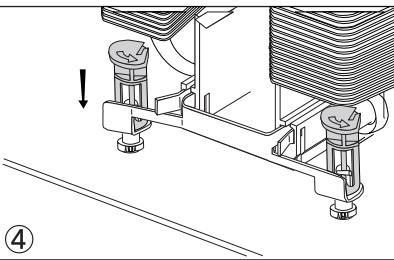
CPUソケットの周りにある4つの穴に、取り付け金具のアンカーの半透明部分を差し込んだ後、アンカーの黒い部分を下にカチリとなるまで押して下さい。取り付けの際、アンカーパートでマザーボードを傷つけないようお気を付け下さい。
