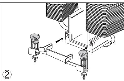
図のようにLGA 775用金具をクーラー本体に取り付けます。外れないようにカチリというまで差し込み部分を奥まで完全に押し込んで下さい。
