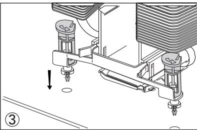
クーラー本体底面(コア接触面)保護シートを引き剥がしたら、コア接触面がCPUのコア部分と平行になるように載せて下さい。
