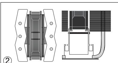
図のようにクーラーファンが中央に来るよう設置して下さい。
