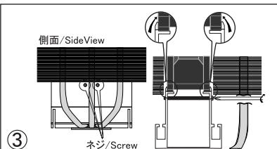
クーラー本体の台座部分にある2本のネジを、クーラーファンがしっかりと固定されるまで締めて下さい。
