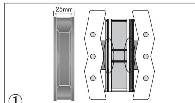
クーラーファンをCPUクーラー本体の台座部分(図参照)にある出っ張りにはまるように載せて下さい。
