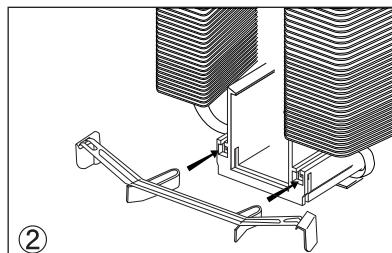
図のようにSocket 478用金具をクーラー本体に取り付けます。外れないようにカチリというまで差し込み部分を奥まで完全に押し込んで下さい。
