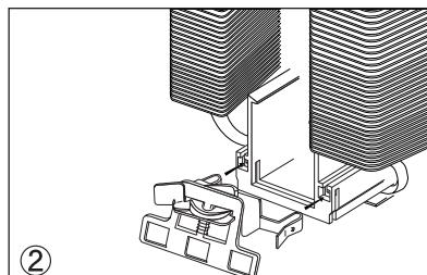
図のようにSocket 754,939,940用金具をクーラー本体に取り付けます。外れないようにカチリというまで差し込み部分を奥まで完全に押し込んで下さい。
