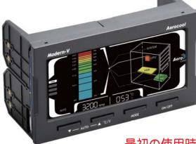
最初の使用時にLCD設定のリセットを行って下さい。 上図のON/OFFボタンを3秒間以上押すことでリセットされます。
