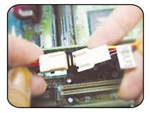
FANコネクタのうち、「FAN1」の タグが付いたコネクタはCPU用と なります。PWM対応FANの4ピンコ ネクタの接続も可能です。
