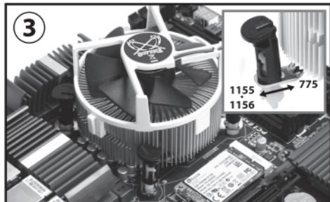
本体をマザーボードの取り付け穴にセットします。CPUの規格に合わせて脚の位置を調節してください。
