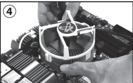
4つのプッシュピンを矢印のマークと逆方向に回してから上に引き上げて、取り付け穴に押し込みます。
