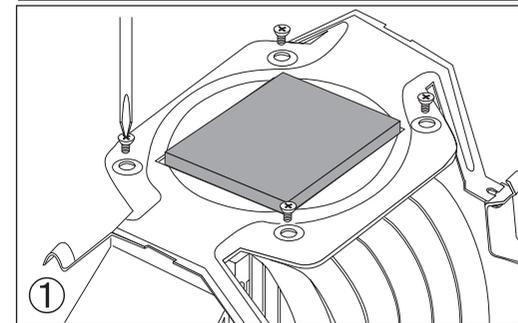
クーラー本体底面(コア接触面)の保護シートを引き剥がし、図のようにSocket 478,LGA 775用取り付け金具をクーラー本体に取り付け金具用ネジ4本にて固定して下さい。
