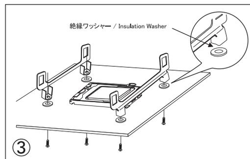
専用リテンション・ブラケットを、マザーボード裏面より取り付けネジを使用して専用バックプレートに固定して下さい。専用リテンション・ブラケットを固定する際、マザーボードと専用リテンション・ブラケットの間に必ず絶縁ワッシャーを入れて下さい。
