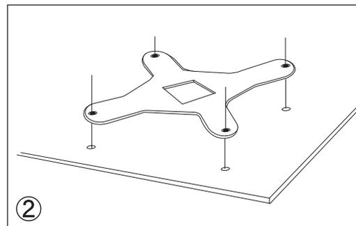
図のように粘着面をマザーボード側にしてLGA775専用バックプレートをマザーボードに取り付けます。
