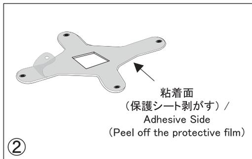
LGA775専用バックプレートの粘着面から保護シートを剥がした後、図のように粘着面をマザーボード側にしてLGA775専用バックプレートをマザーボードに取り付けます。
