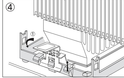
取り付け金具の切り欠き部分をブラケットの両方の突起部分に取り付けます。取り付け金具を取り付ける際、ブラケット部分を損傷しないようお気を付け下さい。
