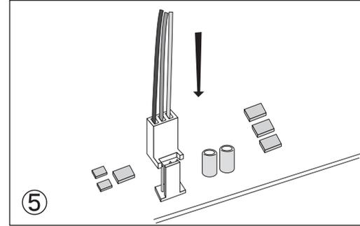
ファンのコネクタをマザーボードに取り付けて下さい。ファンレス運用はマザーボードが回転数を検知出来ないためエラーを起す可能性があります。BIOSでエラー回避等の設定はご使用のマザーボードのマニュアルをご参照下さい。また付属ファンも低回転のためマザーボードによっては回転数を検知出来ない場合があります。
