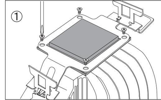
クーラー本体底面(コア接触面)の保護シートを引き剥がし、図のようにSocket 754,939,940,AM2用取り付け金具をクーラー本体に取り付け金具用ネジ4本にて固定して下さい。
