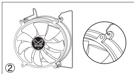
140mmファンに、付属の装着用クリップの先端部分をファンのネジ穴部分に抜けないようにしっかり挿し込んで下さい。
