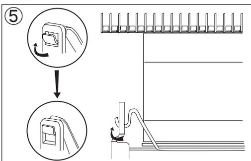
図のようにコア接触面がCPUのコア部分と平行になるように載せ、Socket 478,LGA 775用クリップの留め具部分をブラケットの2つの穴に引っ掛けて下さい。取り付けの際は、ブラケット部分を損傷しないようお気を付け下さい。
