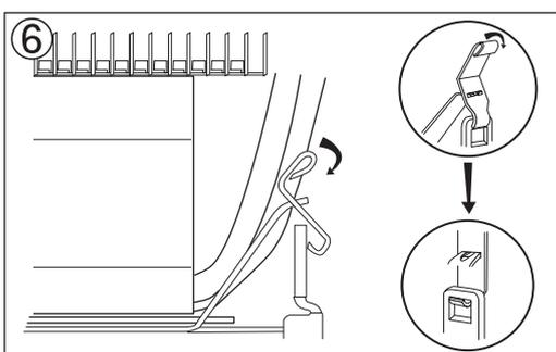
図のようにSocket 478,LGA 775用クリップの留め具部分をブラケットの2つの穴に差し込んで下さい。取り付けの際は、ブラケット部分を損傷しないようお気を付け下さい。
