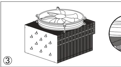
装着用クリップの留め具部分を本体の切り込み部分に掛けてファンをしっかりと固定して下さい。留め具部分が切り込み部分にしっかりと固定されていませんとファンが外れる可能性がありますのでご注意下さい。
