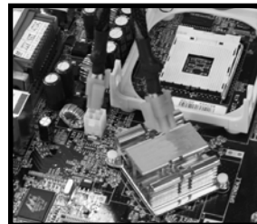
電源側 ATX12V (4ピンのみ使用)
