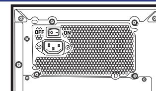
電源ケーブルの接続が完了したら、再度コネクタ類の接続を確認し、電源ユニット背面のパワースイッチを「ON」に切り替えてから、パソコンケースのパワースイッチを押し、パソコンを起動させてください。
