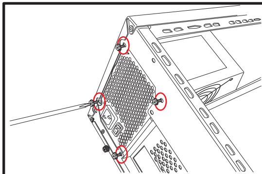
電源ユニットをケースの所定の場所に置き、ネジ止めしてください。
