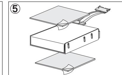
内部ケースの上下部分に熱伝導ゲルシートを貼って下さい。(熱伝導ゲルシートには保護シールが貼っていますので、必ず剥がしてからご使用下さい。)
