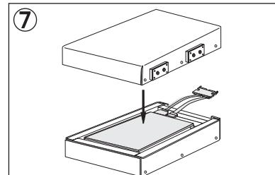
外部ケースのケース下部に蓋部分を取り付けます。(蓋部分を取り付ける際、IDEケーブル等をケース部分に挟まないようお気を付け下さい。)
