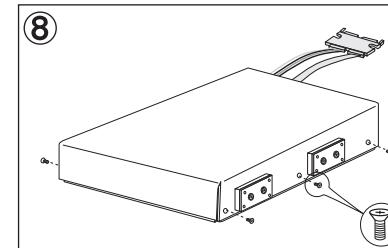
外部ケースのケース下部に蓋部分を合わせましたら、外部ケース用ネジを用いてケースを固定して下さい。
