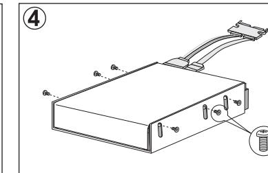
内部ケースの蓋部分とケース下部を合わせたら内部ケース用ネジを用い、ケースとハードディスクを密着させて固定して下さい。
