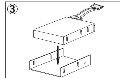
内部ケースの蓋部分を被せたハードディスクをケース下部のネジ穴部分に重なる様に合わせて下さい。
