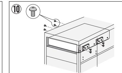
パソコンケース取り付け用ネジを用いQuiet Drive本体をパソコンケースに固定して下さい。(ネジを強く締めすぎると本体内部の金属部分がゴム部分より剥離する恐れがあります。)
