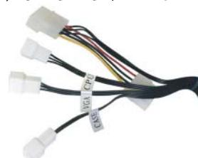
左図の3ピンオスコネクタにお使いのファンを接続して下さい。4ピンコネクタタイプのファンはパルス信号線がないため3ピンコネクタに変換して接続されても本ファンコントローラーの機能はお使いになれません。
