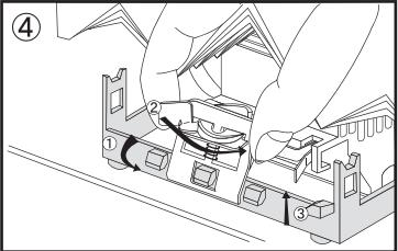
コア接触面がCPUのコア部分と平行になるように載せ
