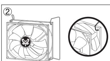
120mmファンに、付属の120mmファン装着用クリップの先端部分をファンのネジ穴部分に抜けないようにしっかりと挿し込んで下さい。
