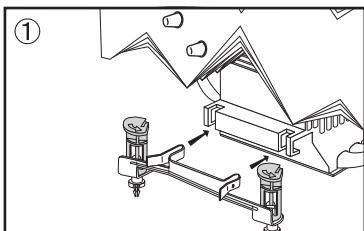
クーラー本体底面(コア接触面)の保護シートを引き剥がし、図のようにLGA用取り付け金具をクーラー本体にカチリというまで奥に完全に押し込み取り付けます。
