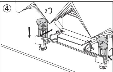
CPUソケットの周りにある4つの穴に、LGA用取り付け金具のアンカーの半透明部分を差し込んだ後、アンカーの黒い部分を下にカチリとなるまで押して下さい。取り付けの際は、アンカー部分でマザーボードを傷つけないようお気を付け下さい。
