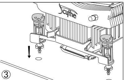
クーラー本体底面(コア接触面)保護シートを引き剥がしたら、コア接触面がCPUのコア部分と平行になるように載せて下さい。
