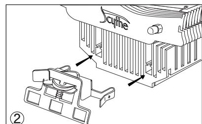
図のようにSocket 754,939,940用金具をクーラー本体に取り付けます。外れないようにカチリというまで差し込み部分を奥まで完全に押し込んで下さい。
