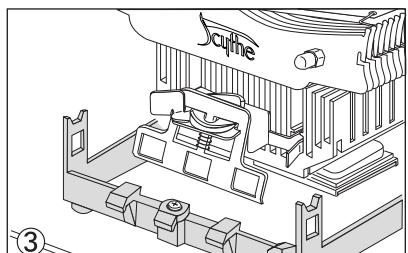
クーラー本体底面(コア接触面)保護シートを引き剥がしたら、コア接触面がCPUのコア部分と平行になるように載せて下さい。
