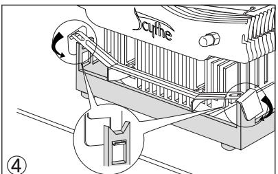
金具の爪部分をリテンション・ブラケットの穴に差し込んで下さい。ブラケットを取り付ける際、ブラケット部分を損傷しないようお気を付下さい。
