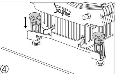
CPUソケットの周りにある4つの穴に、取り付け金具のアンカーの半透明部分を差し込んだ後、アンカーの黒い部分を下にカチリとなるまで押して下さい。取り付けの際、アンカーパートでマザーボードを傷つけないようお気を付け下さい。
