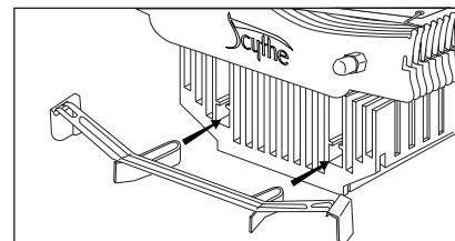
図のようにSocket 478用金具をクーラー本体に取り付けます。外れないようにカチリというまで差し込み部分を奥まで完全に押し込んで下さい。
