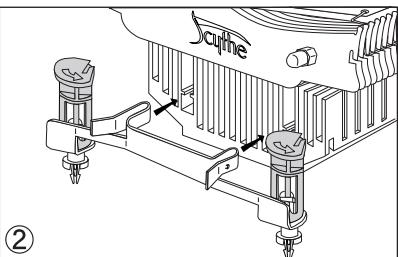
図のようにLGA 775用金具をクーラー本体に取り付けます。外れないようにカチリというまで差し込み部分を奥まで完全に押し込んで下さい。
