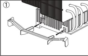
クーラー本体底面(コア接触面)の保護シートを引き剥がし、図のようにSocket 478取り付け金具をクーラー本体にカチリというまで奥に完全に押し込み取り付けます。
