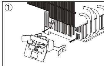
クーラー本体底面(コア接触面)の保護シートを引き剥がし、図のようにSocket 754,939,940,AM2,AM2+,AM3用取り付け金具をクーラー本体にカチリというまで奥に完全に押し込み取り付けます。
