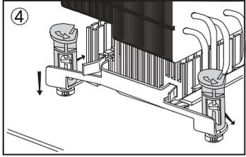
CPUソケットの周りがある4つの穴に、LGA用取り付け金具のアンカーの半透明部分を差し込んだ後、アンカーの黒い部分を下にカチリとなるまで押して下さい。取り付けの際は、アンカー部分でマザーボードを傷つけないようお気を付け下さい。
