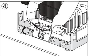
取り付け金具の切り欠き部分をブラケットの両方の突起に取り付けます。取り付け金具についてのレーマーを図のように指で摘んで回しますと切り欠き部分が上方に移動しクーラー本体を固定します。
