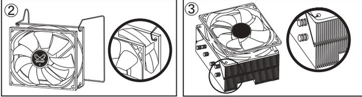
92mmファンに、付属の92mmファン装着用クリップの先端部分をファンのネジ穴部分に抜けないようしっかりと押し込んで下さい。
