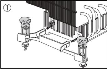
クーラー本体底面(コア接触面)の保護シートを引き剥がし、図のようにLGA用取り付け金具をクーラー本体にカチリという音で奥に完全に押し込み取り付けます。
