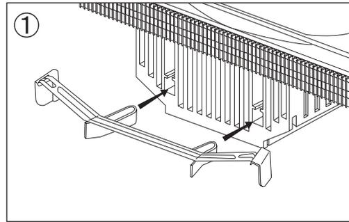
図のようにSocket 478用取り付け金具の差し込み部分をクーラー本体にカチリというまで奥まで完全に押し込み取り付けます。
