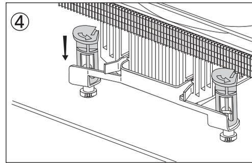
CPUソケットの周りにある4つの穴に、取り付け金具のアンカーの半透明部分を差し込んだ後、アンカーの黒い部分を下にカチリとなるまで押しして下さい。取り付けの際、アンカー部分でマザーボードを傷つけないようお気を付け下さい。
