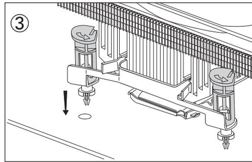
クーラー本体底面(コア接触面)の保護シートを引き剥がしたら、コア接触面がCPUのコア部分と平行になるように載せて下さい。
