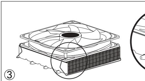
装着用クリップの留め具部分を本体の切り込み部分に掛けてファンをしっかりと固定して下さい。留め具部分が切り込み部分にしっかり固定されていませんとファンが外れる可能性がありますのでご注意ください。
