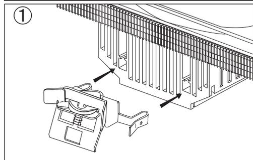
図のようにSocket 754,939,940,AM2用取り付け金具の差し込み部分をクーラー本体にカチリというまで奥まで完全に押し込み取り付けます。
