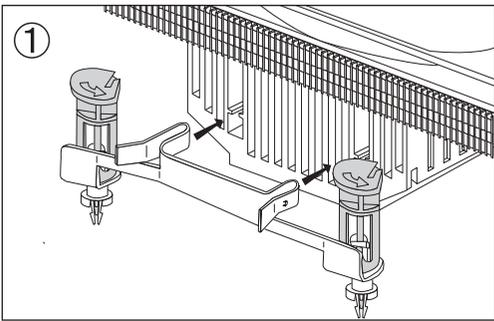
図のようにLGA 775用取り付け金具の差し込み部分をクーラー本体にカチリというまで奥まで完全に押し込み取り付けます。
