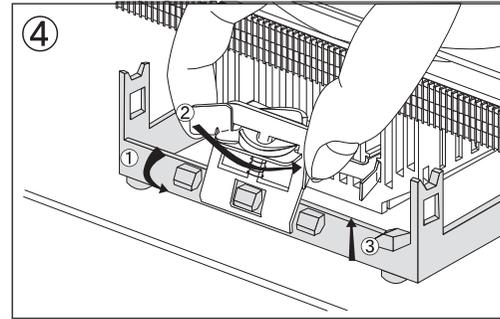
取り付け金具の切り欠き部分をブラケットの両方の突起に取り付けます。取り付け金具についてのレバーを図のように指で摘んで回しますと切り欠き部分が上方に移動しクーラー本体を固定します。
