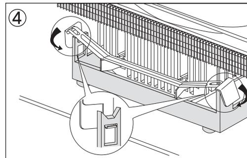
取り付け金具の留め具部分をブラケットの4つの穴に差し込んで下さい。取り付け金具を取り付ける際、ブラケット部分を損傷しないようお気を付け下さい。
