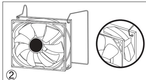
100mmファンに、付属の装着用クリップの先端部分をファンのネジ穴部分に抜けないようにしっかり挿し込んで下さい。
