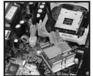
電源側 ATX12V (4ピンのみ使用)
