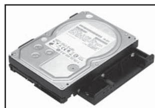
HDD取り付け例
