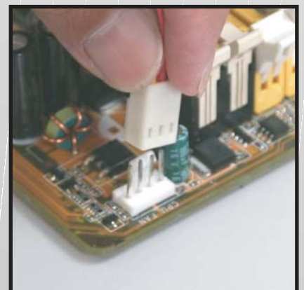
8. 搭載ファンのケーブルをマザーボード上の3ピンコネクタに接続して下さい。
