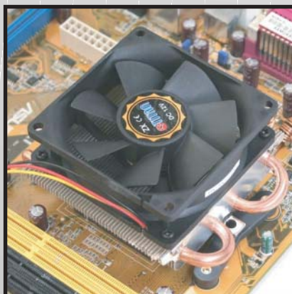
6. CPUクーラー本体をCPUコアに乗せてネジ位置を合わせて下さい。
