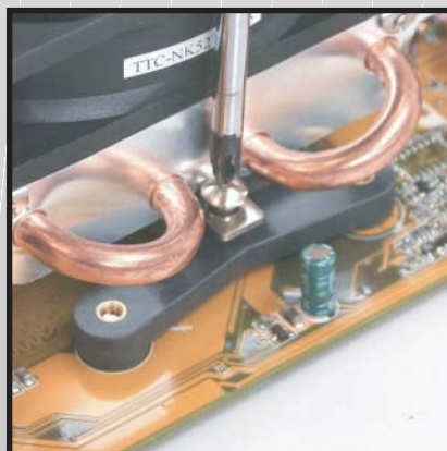
7. 付属のネジでクーラー本体を固定して下さい(計2箇所)。
