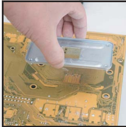
2. マザーボードのバックプレートも外して下さい。
