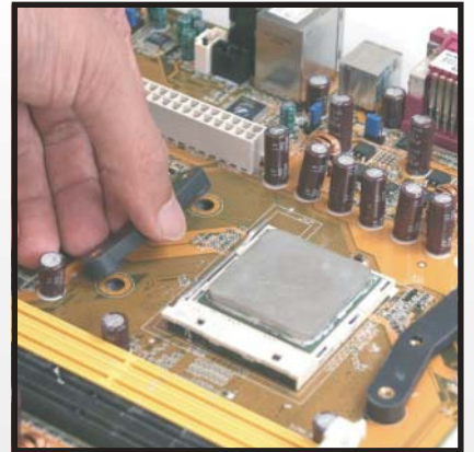
3. 付属の樹脂製マウントパーツのネジ穴とマザーボードのスルーホール(穴)の位置を合わせて下さい。
