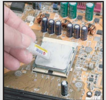
5. CPUコアに、付属のグリスを薄く均一に塗布して下さい。
